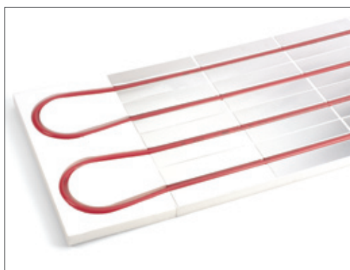
Podlahové vykurovanie v kompaktnom „suchom systéme“ s výškou 30 mm bez betonáže poteru, prekrytie sadrovláknitými doskami 25 mm
